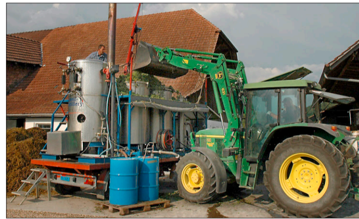
Aus einer Charge von 2000 Liter Inhalt werden in 2 Stunden 30 Milliliter kostbares Zitronenmelissenöl destilliert. (Bild: rh)
